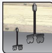
3. Insérer la tige filetée dans le piton femelle et le cavalier pivot sur la tige filetée
