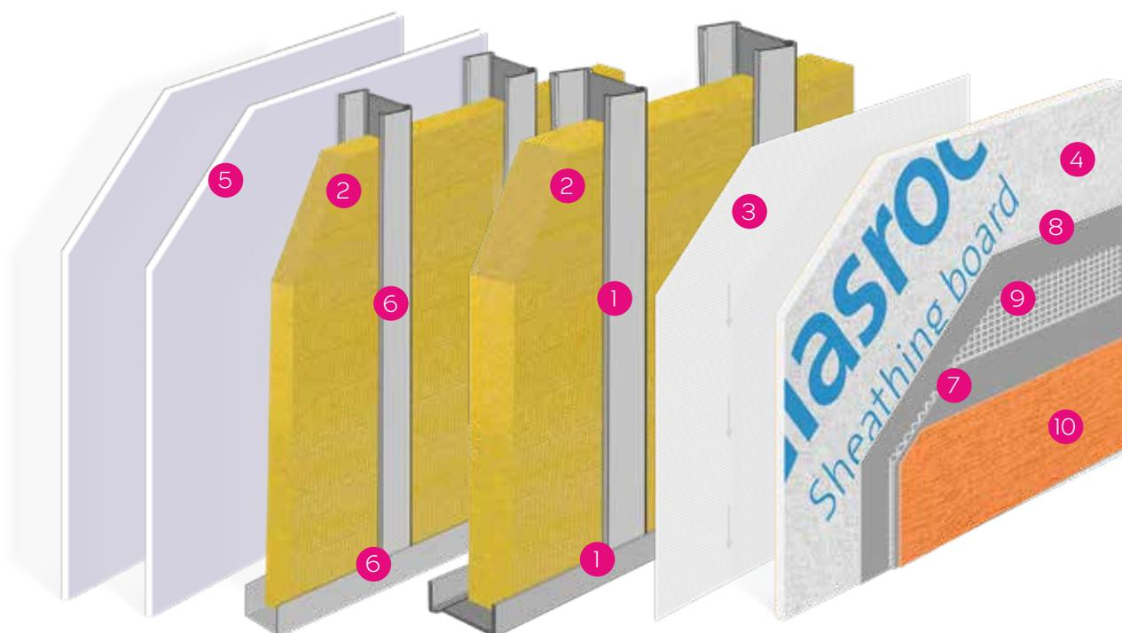
1 Perfis THM y THR: estrutura exterior formada por montantes e rails ancorados no solo e teto.
