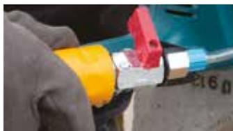
• Sistema de água integrado com ajuste de fluxo para trabalhos de corte de aço.
