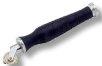
POUR LES SOUDURES DES REVÊTEMENTS DE SOL SOUPLES DANS LES ANGLES
